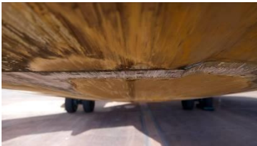
Figura 19. Deformación en cuaderna del fuselaje
