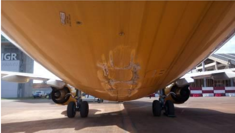
Figura 2. Daños en la zona ventral trasera del fuselaje
